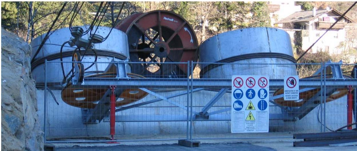
Foto 11. Tamburi di ancoraggio delle funi portanti della teleferica installata per la costruzione della centrale "Enerpass" in Val Passiria (BZ).
